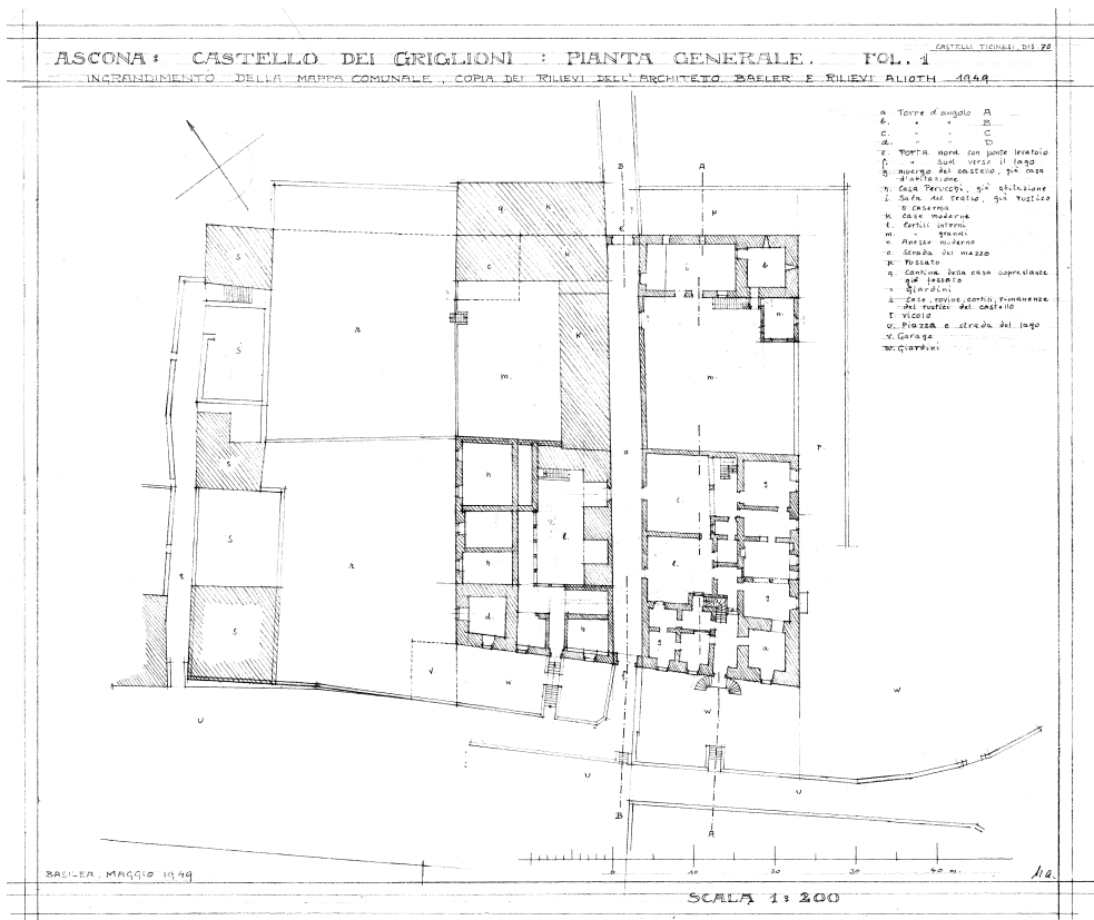
Abb. 6: Ascona, Cast. dei Griglioni. Grundrissplan von Friedrich Baeler und Max Alioth (1949). Die Kastellanlage ist im Prinzip noch erkennbar. Von den vier Ecktürmen ist lediglich der Nordwestturm bereits verschwunden und überbaut.
